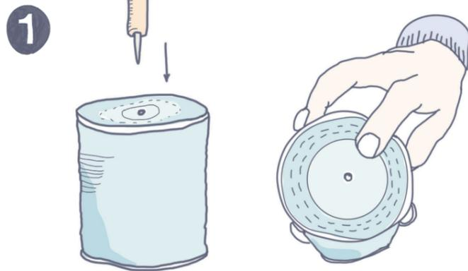
1 Bohre in die untere Seite der Metalldose ein Loch. Am besten ist es, dass die Dose auch einen Deckel hat.
